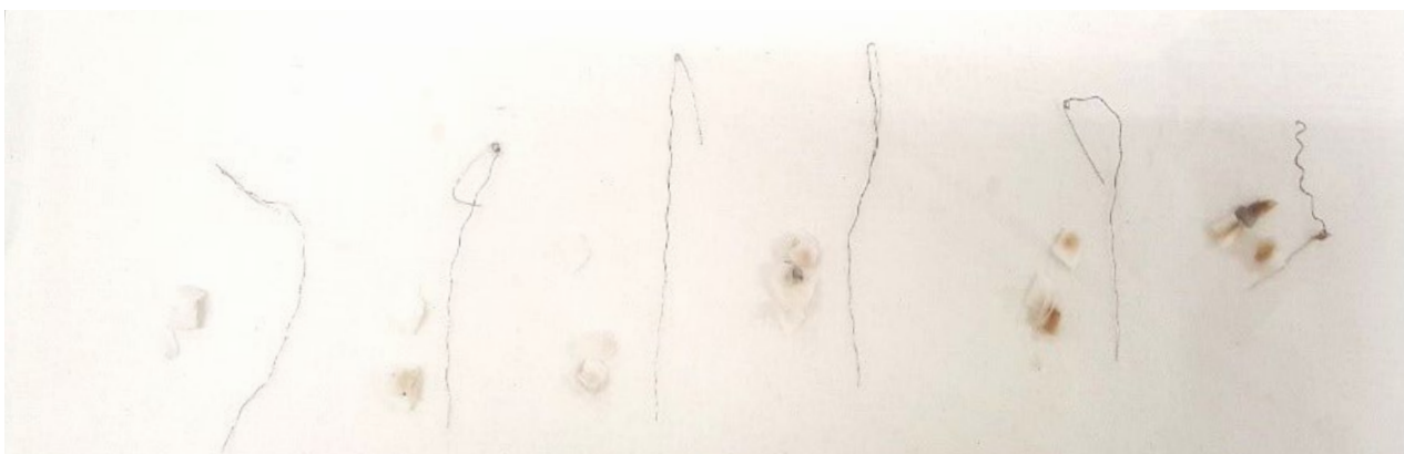
Figure 9 : Mèches des résistances obtenues lors de la vaporisation d'e-liquides (PG/VG 20/80), nicotiné à 20mg/mL et à différents taux de sucralose avec le clearomiseur Zenith. De gauche à droite, les concentrations en sucralose sont de 1,5-3-5-6,5-8-10mg/mL.
