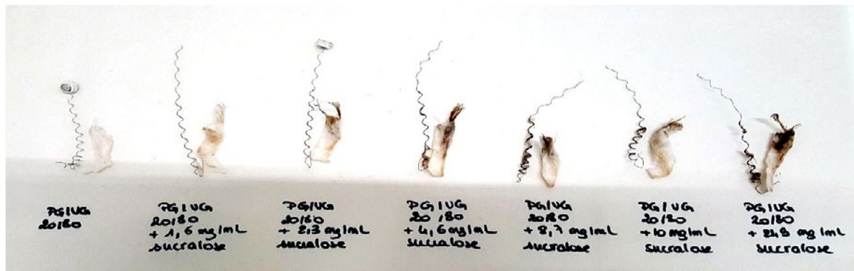
Figure 7 : Mèches des résistances obtenues lors de la vaporisation d'e-liquides (PG/VG 20/80), nicotiné à 20mg/mL et à différents taux de sucralose avec le clearomiseur CUBIS. De gauche à droite, les concentrations en sucralose sont de 1,6-2,3-4,6-8,7-10mg/mL.
