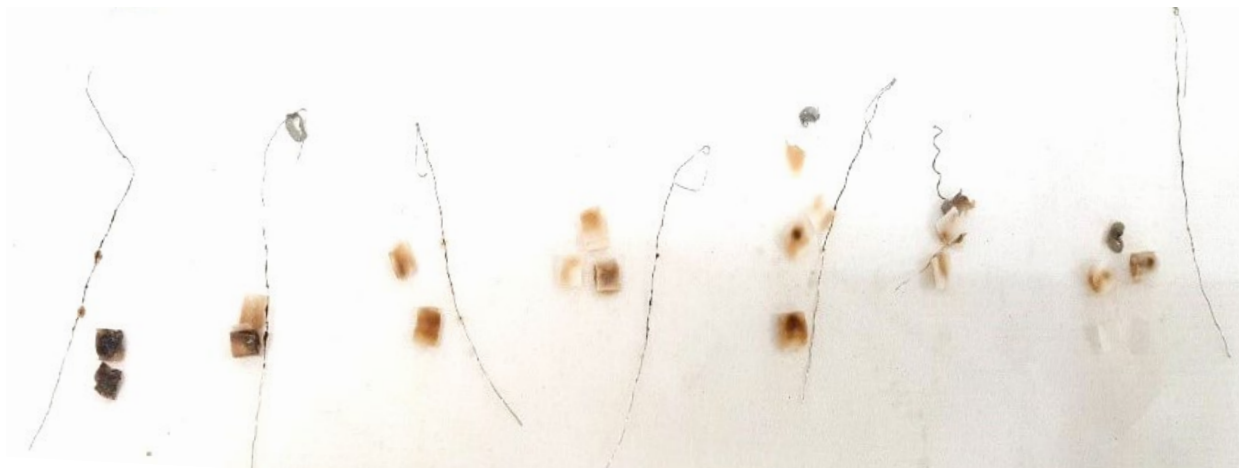
Figure 10 : Mèches des résistances obtenues lors de la vaporisation d'e-liquides à différent taux de PGVG et contenant chacun 20mg/mL de nicotine et 10mg/mL de sucralose avec le clearomiseur Zenith. De gauche à droite, les taux de PG/VG sont : 100%PG ; 80/20 ; 70/30 ; 50/50 ; 30/70 ; 20/80 ; 100%VG.
